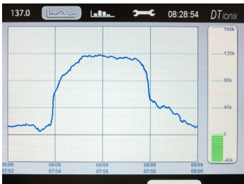
Injection de 100 kBq/m 3 sur un C IONIX 3 - BMM
