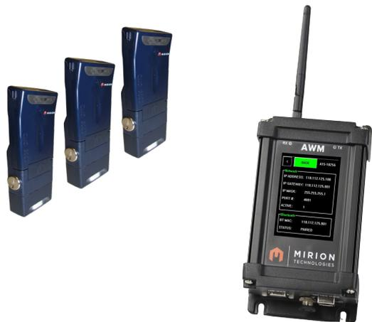
Exemple de système de télémétrie Mirion (DMC3000 avec module eTx + AWM + Telemetry Studio)
