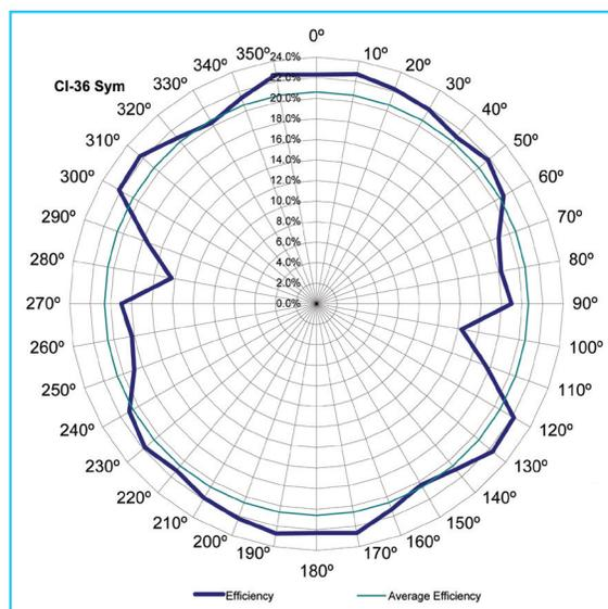
Argos-3/-5PB Efficacité de balayage horizontal pour <sup>36</sup>Cl, Test fantôme (conf. à la norme CEI 61098) à 5 cm de détecteur central
