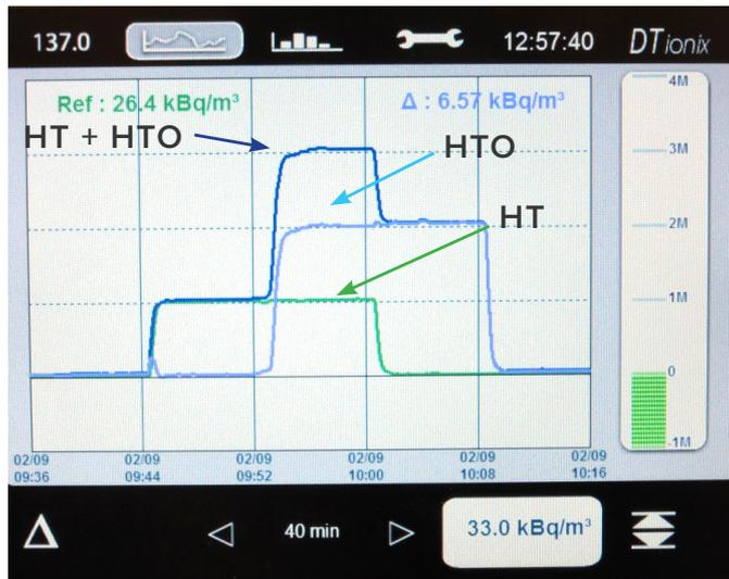
Injection de 1 MBq/m<sup>3</sup> de tritium sous forme HT puis de 2 MBq/m<sup>3</sup> de tritium sous forme HTO. L'injection de HT est ensuite stopée puis celle de HTO est stopée également.
