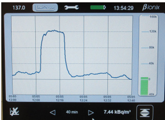
Exemple de réponse à 100 kBq/m 3 B IONIX 3 – MES Activité volumique mesurée
