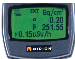
Affichage avec sonde alpha/bêta
