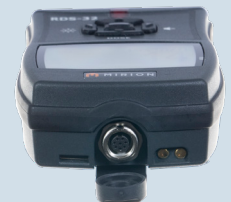
Connecteur, contacts de charge, patte de fixation pour sangle de port au poignet
