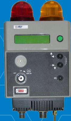
Analyse spectrale gamma avec identification des isotopes.
