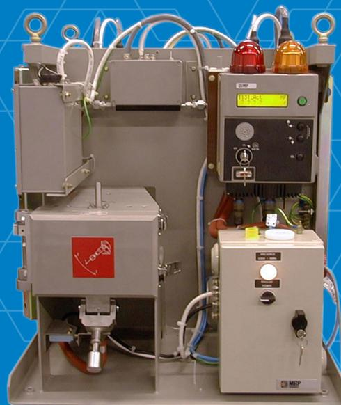
**Mesure en continu de l'activité volumique gamma de l'iode radioactif, sous forme moléculaire et organique, présent dans les gaines de ventilation, les cheminées, les zones de travail.**
