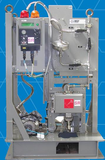
Mesure en continu de l'activité volumique gamma de l'iode radioactif, sous forme moléculaire et organique, présent dans les gaines de ventilation, les cheminées, les zones de travail. Résistant aux conditions sismiques.
