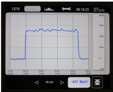
Injection de 500 kBq/m<sup>3</sup> sur un C IONIX 3 - BMM
