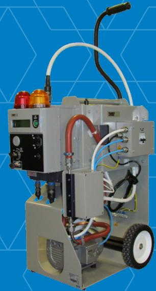
**Surveillance de l'air extrait des conduits de ventilation et des cheminées.**
