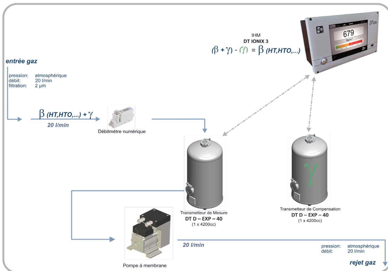
Schéma fluide pour un C IONIX 3 - EXC
