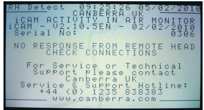
Le fonctionnement normal reprend automatiquement une fois les communications restaurées. L'étalonnage de la tête est effectué comme pour l'iCAM standard. Il n'y a pas d'ajustement sur la tête. Si des ajustements sont nécessaires, ils sont réalisés au niveau de l'unité de contrôle où l'utilisateur peut lire les écrans de calibration et ajuster en conséquence.
