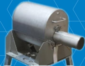
**Mesure en continu de la concentration en bore dans l'eau du circuit primaire dans les centrales nucléaires à eau légère.**
