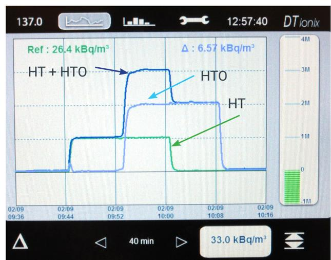
Injection de 1 MBq/m<sup>3</sup> de tritium sous forme HT puis de 2 MBq/m<sup>3</sup> de tritium sous forme HTO. L'injection de HT est ensuite stoppée puis celle de HTO est stoppée également.
