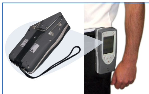
Figure 4 : dragonne poignet, doigt (gauche) ; clip ceinture (droite)
