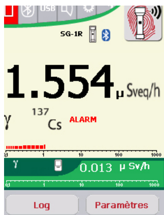
Figure 3 : Colibri avec une sonde externe unique
