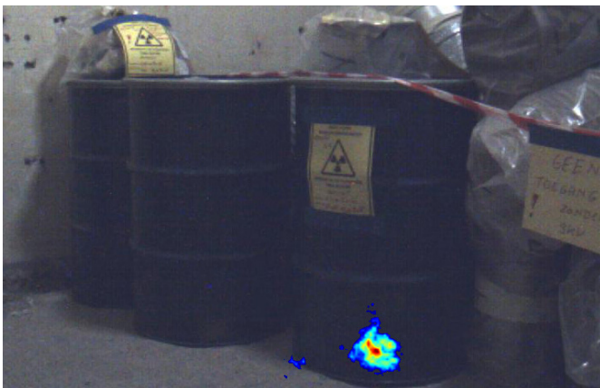
Localisation de point chaud sur des fûts
