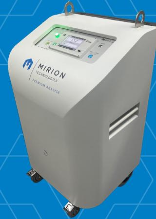
Détecteur mobile de tritium pour les applications de radioprotection, contrôle de process, surveillance de l'environnement, laboratoire et démantèlement
