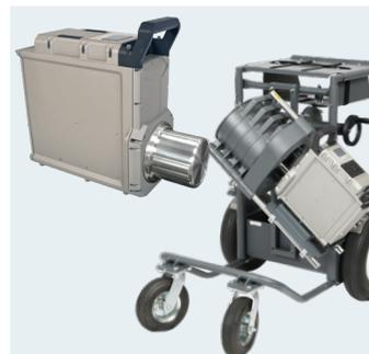
Spectromètre GeHP transportable AEGIS™
