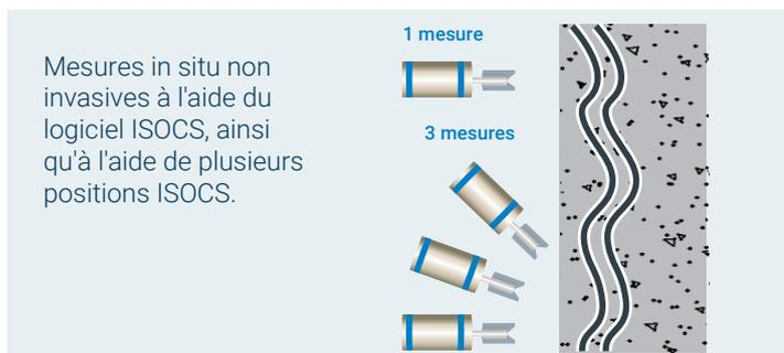
Mesures in situ non invasives à l'aide du logiciel ISOCS, ainsi qu'à l'aide de plusieurs positions ISOCS.
