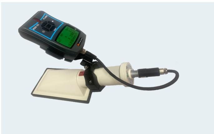
Le RDS-32 peut accueillir une famille de sondes CSP-Smart pour une détection améliorée du débit de dose gamma et une surveillance de la contamination  $\alpha$ - $\beta$  ( $\gamma$ ).
