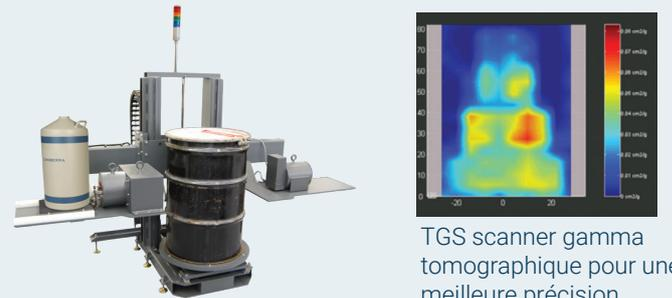
SGS scanner gamma segmenté pour caractérisation des déchets
