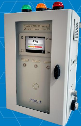
Coffret de détection de gaz noble pour toutes applications de surveillance de locaux, de chantiers de démantèlement, de contrôles de rejet de cheminée ou autres,...
