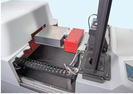
Les détecteurs de garde et d'échantillons peuvent coulisser aisément hors du blindage pour la maintenance
