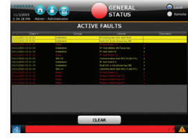
Rouge pour un défaut majeur : la fonction de sécurité est potentiellement affectée (les alarmes pourraient ne pas être émises en cas d'accident de criticité)
