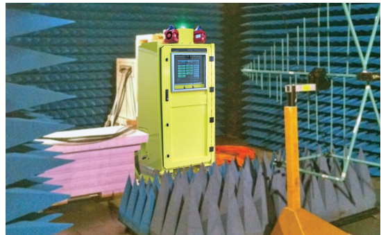
Essais CEM sur les baies du CAAS
