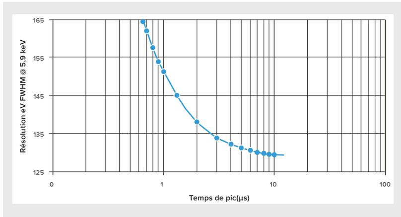
Figure 2 : Résolution typique en fonction du temps de pic avec sommet plat de 0,1 µs à -35 °C.
