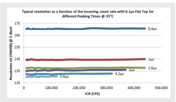
Figure 3 - T Résolution typique en fonction du taux de comptage entrant avec un sommet plat de 0,1  $\mu s$  pour différents temps de pic à -35  $^{\circ}C$
