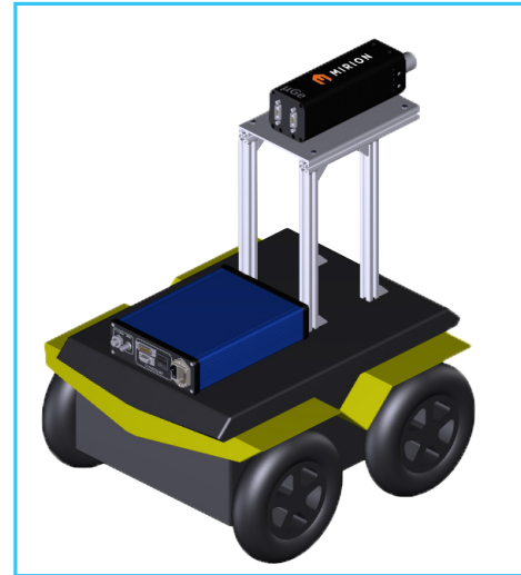
Intégration du MicroGe sur un rover
